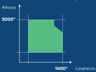
\*Le dimensioni massime dipendono da molteplici parametri, tra cui i requisiti del carico del vento e la scelta del tipo di vetro.
