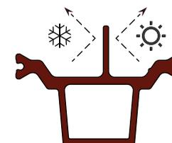
Nuova guarnizione centrale in EPDM coestruso, con corpo centrale in espanso a bassa conducibilità termica e pinna aggiuntiva per ridurre lo spazio libero tra telaio e anta
